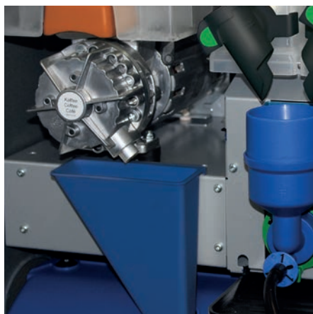
Un entonnoir guide le café moulu directement du moulin à la chambre d'infusion
