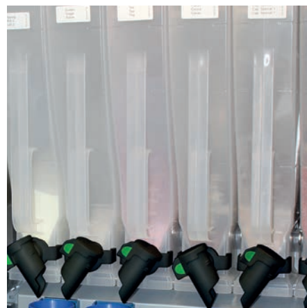
« SiTwist'n-Lock » : bouchons de fermeture des bacs instantanés avec marquage couleur de la position: ouvert (vert) et fermé (rouge)
