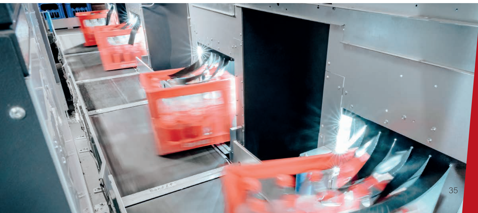
Abbildung: Eine 4er Kastenweiche
